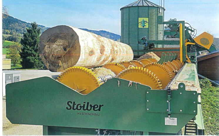
Der Fräsvorgang kann mit einer Fernbedienung gestartet werden, der Ablauf erfolgt dann vollautomatisch
