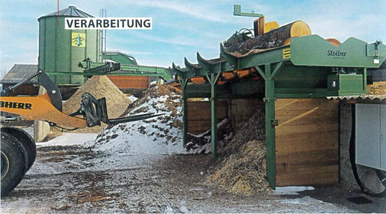
Der Mitarbeiter gibt die Stämme per Radlader auf die neue Fräskopfentrindung samt Wurzelreduzierer von Stoiber auf
