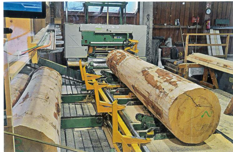
Die perfekt entrindeten Stämme gelangen im Anschluss zum Einschnitt auf die Blockbandsäge
