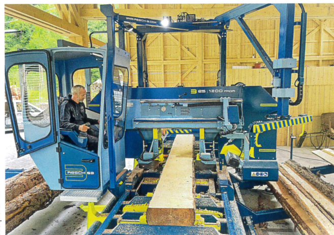
Optimale Sicht auf das Holz, das Bandsägeblatt und die beiden Vorschneider
